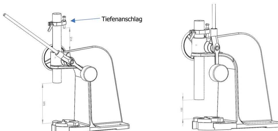
Nach dem Verstellvorgang und der Inbetriebsetzung der Presse muss sowohl der Klemmhebel als auch die Mutter an der Einstellschraube auf Festigkeit überprüft werden, um ein selbsttätiges Verstellen zu vermeiden.
