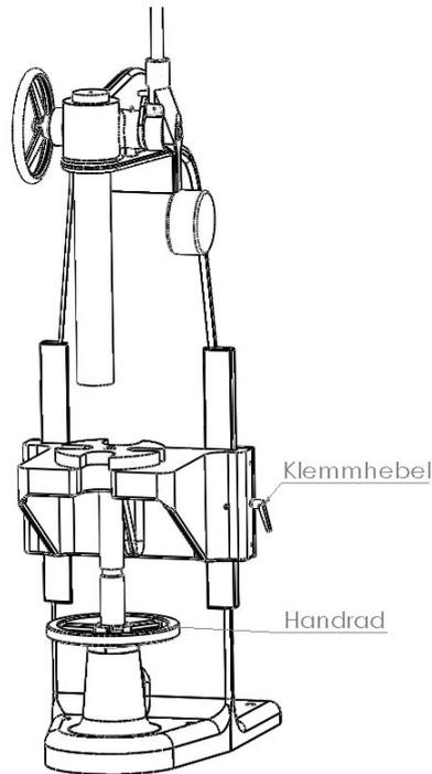
Hierfür lösen Sie den Klemmhebel auf der rechten Seite des Tisches um eine Beschädigung der Spindel oder der Führung auszuschließen. Anschließend lässt sich der Tisch an dem Handrad leicht in seiner Position verstellen.
